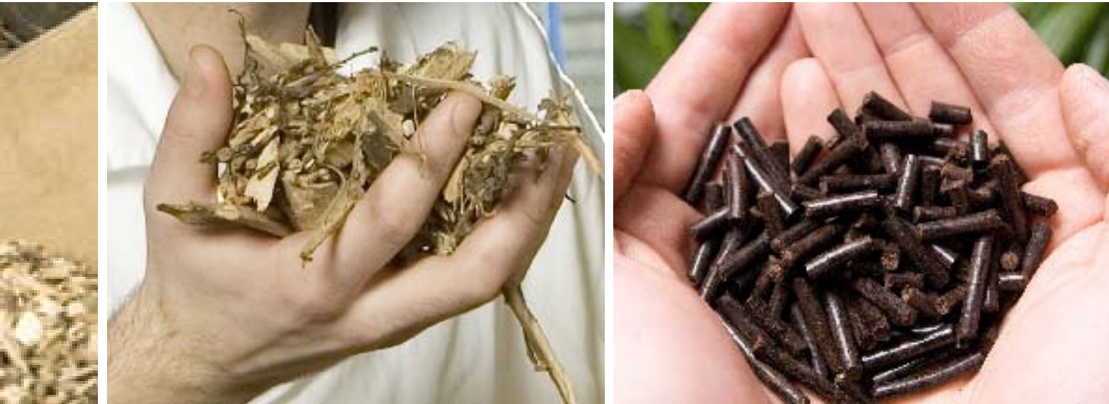
Restproducten als plantenstengels, oneetbare bladeren en afvalhout worden opgewerkt tot brandstofpellets
